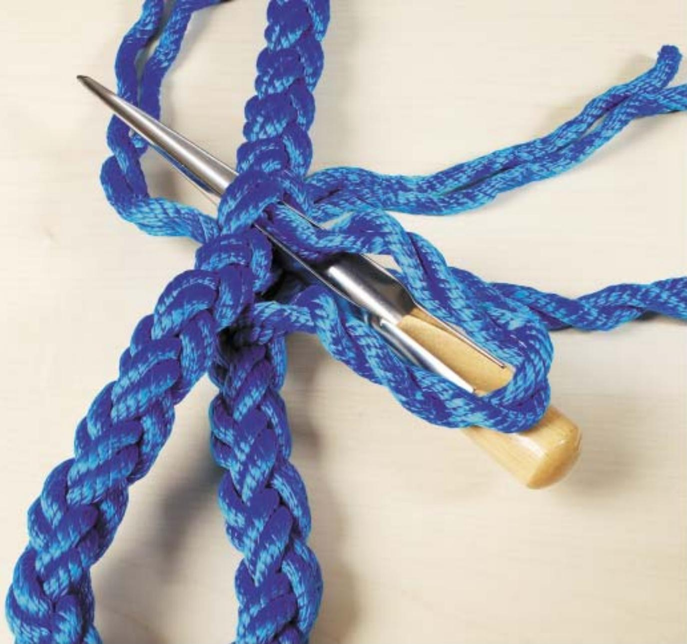
Jetzt die 2 Litzen von rechts mit Hilfe des Hohlspiekers unter 2 Litzen einführen.
