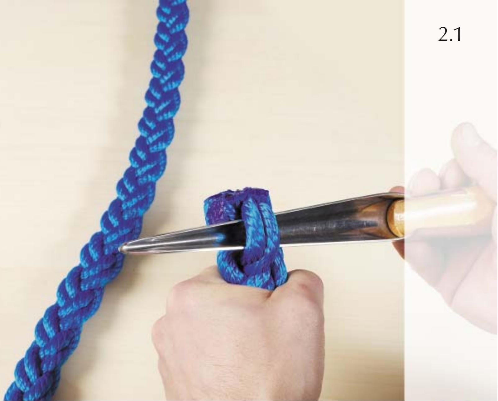
Öffnen des abgeschweißten Seiles mit dem Hohlspieker.
