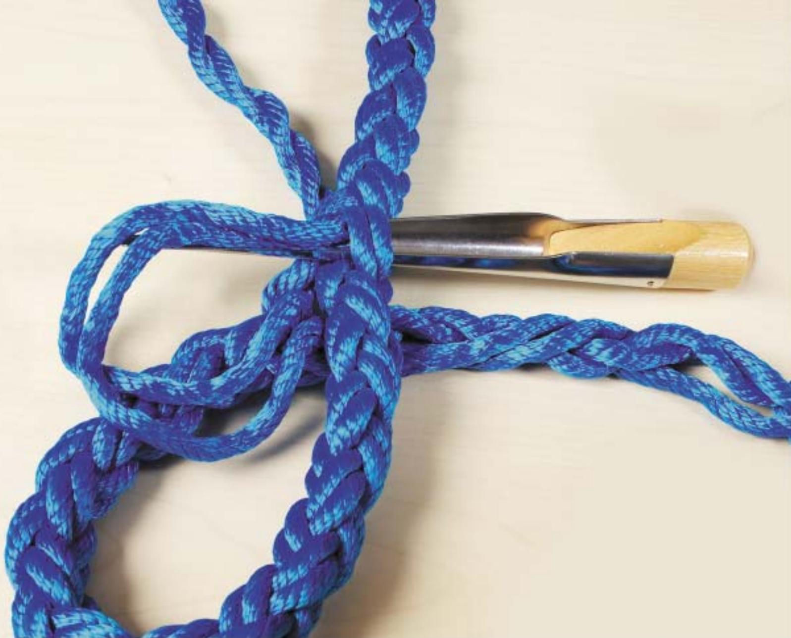
Jetzt die 2 Litzen von links mit Hilfe des Hohlspiekers unter 2 Litzen einführen.
