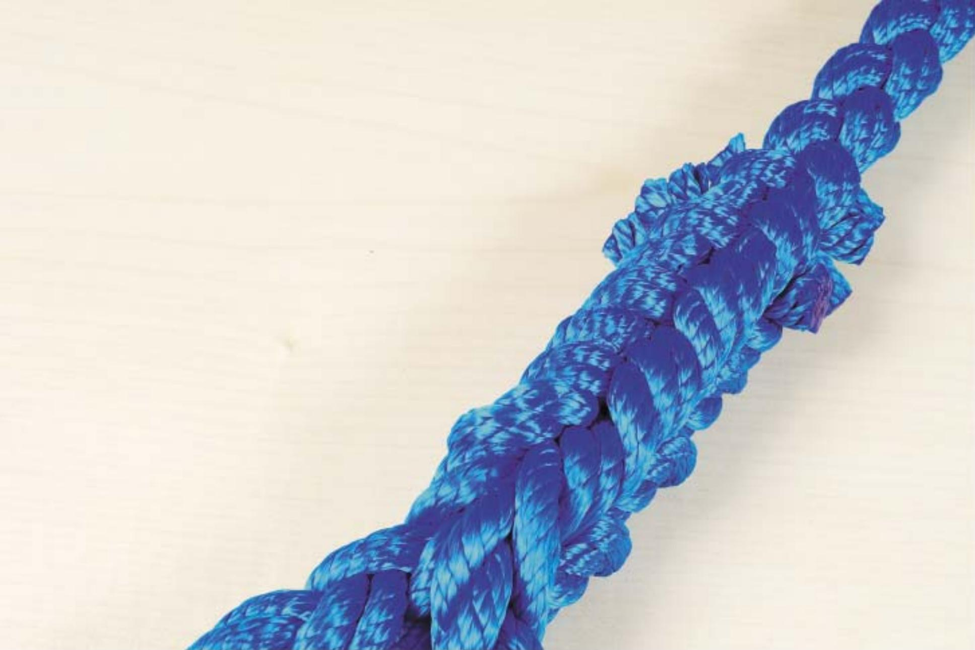
Fertiger Spleiß (Überstände passen sich durch Spannung dem Seil an).
