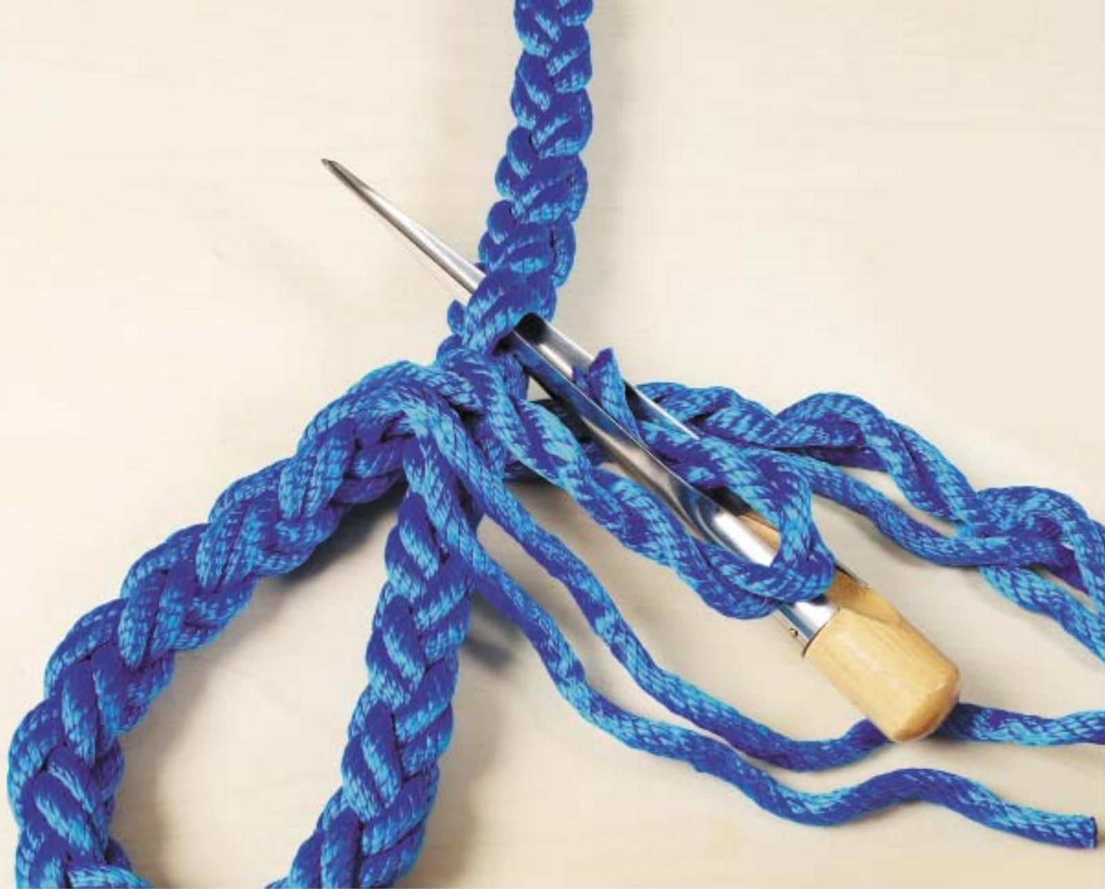
Hohlspeker unter 2 Litzen einführen und 2 Litzen durchstecken.
