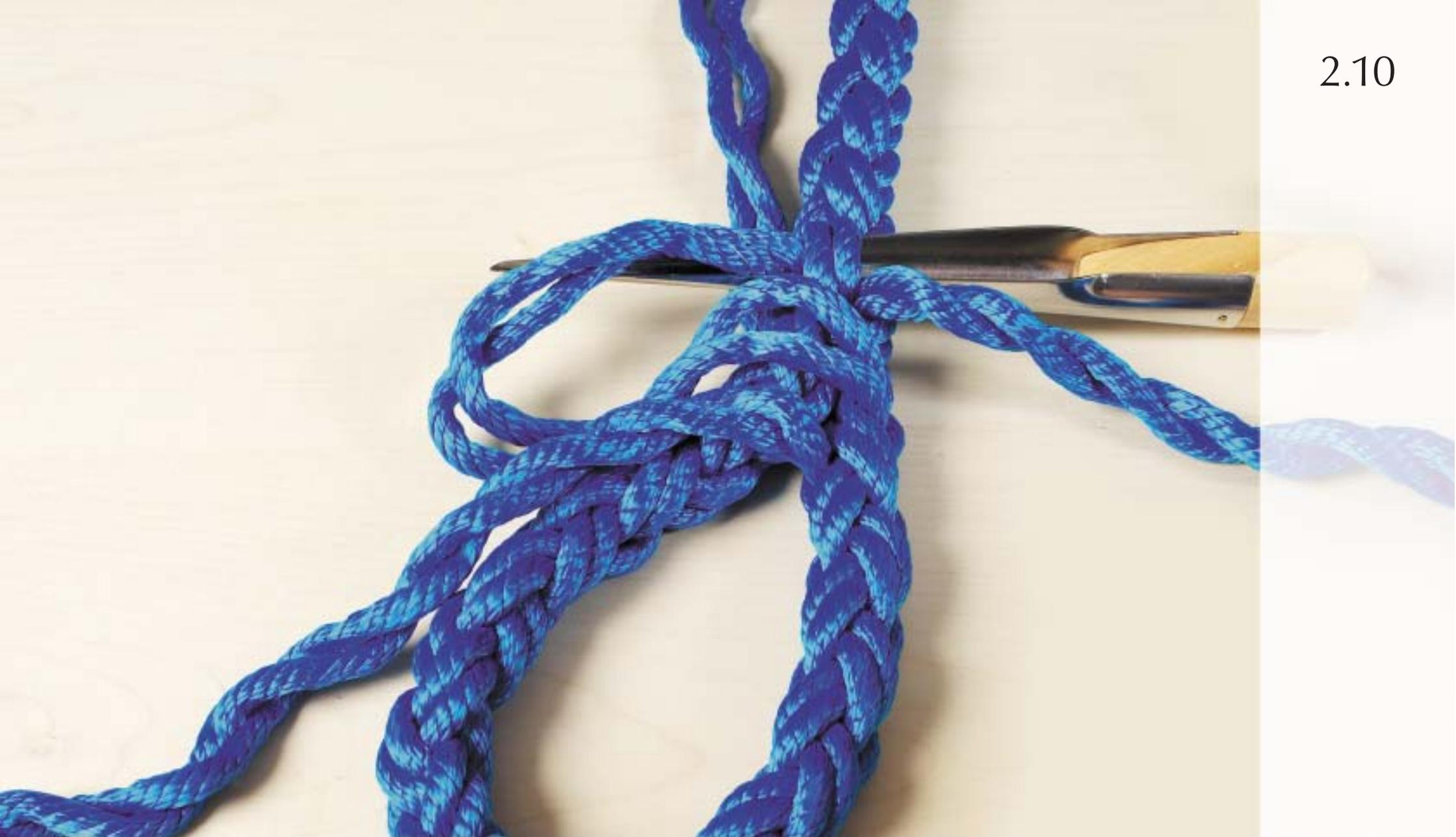
Wieder die 2 Litzen von links mit Hilfe des Hohlspiekers unter 2 Litzen einführen.
