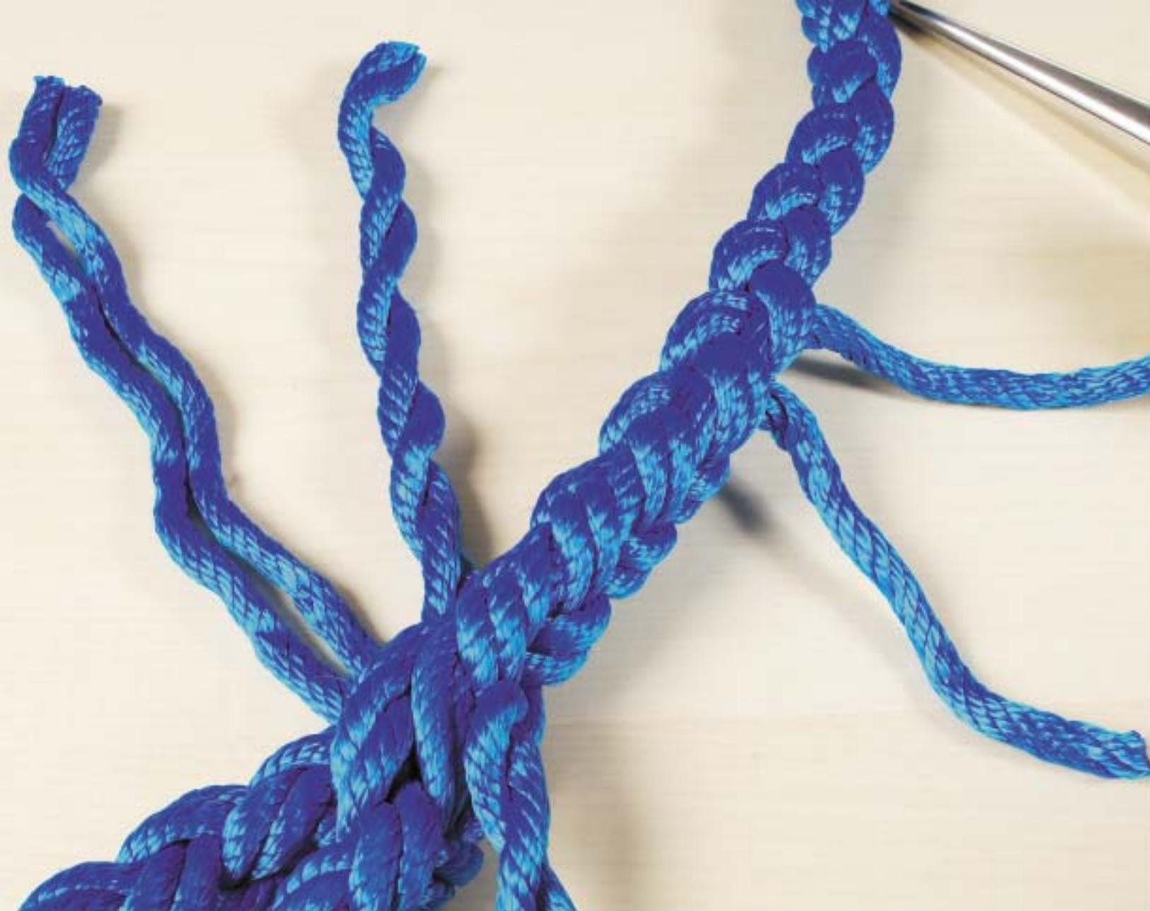
Faites au minimum 4 passages avec 1 x 2 torons autour d' 1 x 2 torons. Pour le dernier passage ne prendre qu'un seul toron pour effiler l'épissure.
