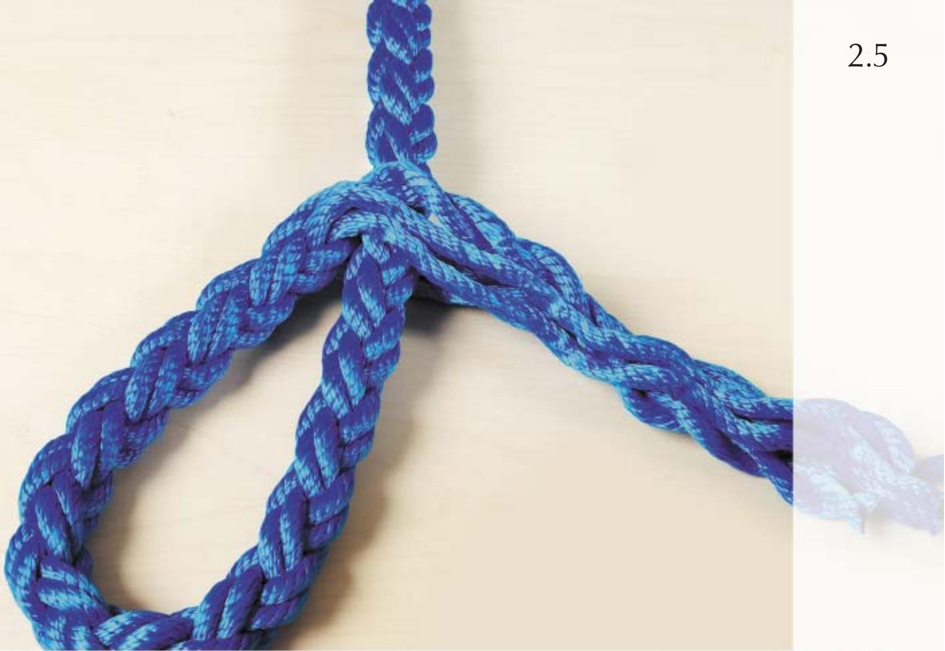
Déterminez la taille de la boucle, et faites passer la moitié des torons sur, et l'autre moitié sous le cordage.
