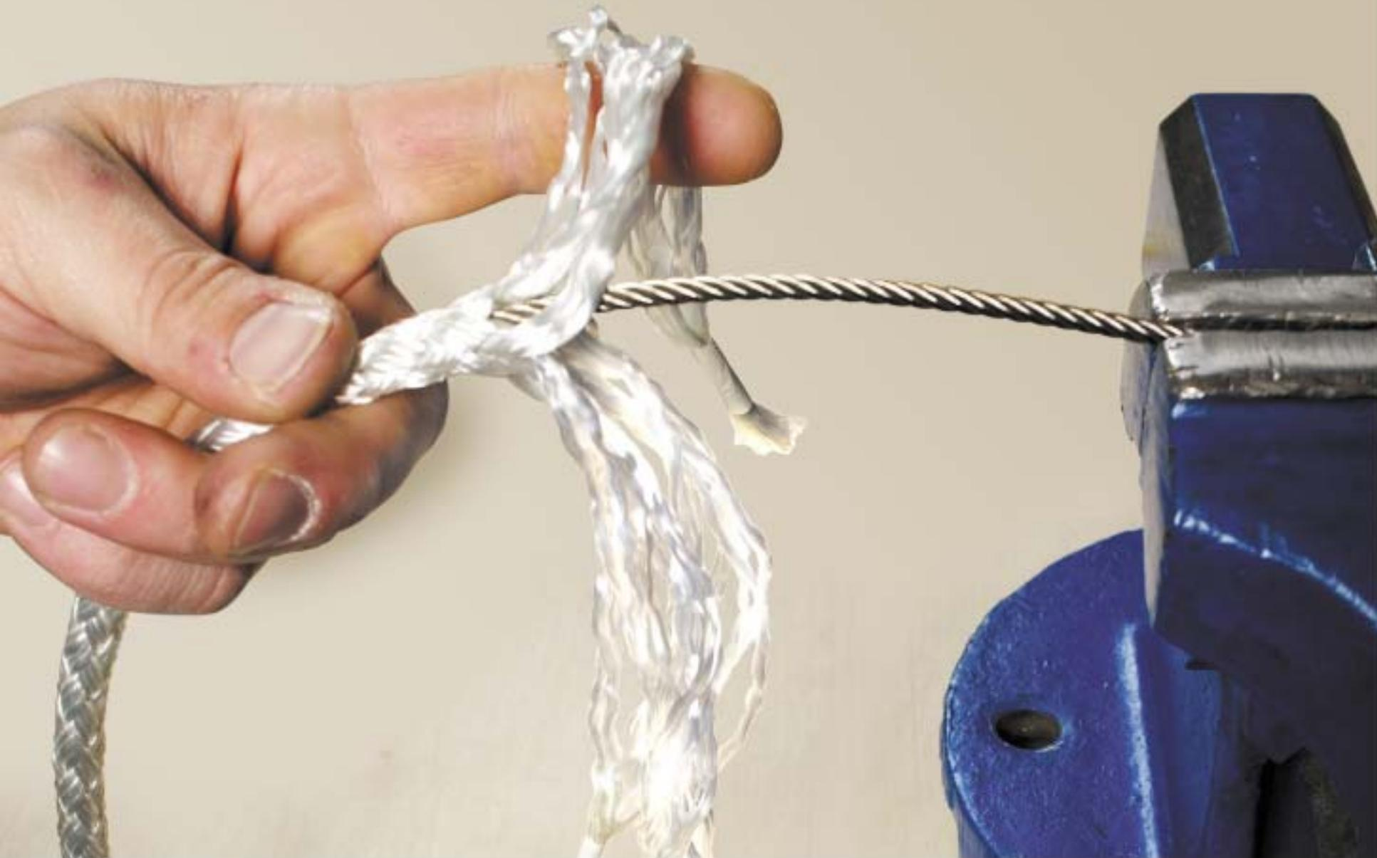
Bloquez le câble dans l'étau, et formez trois faisceaux environ équivalents avec 15 cm de fils détressés.
