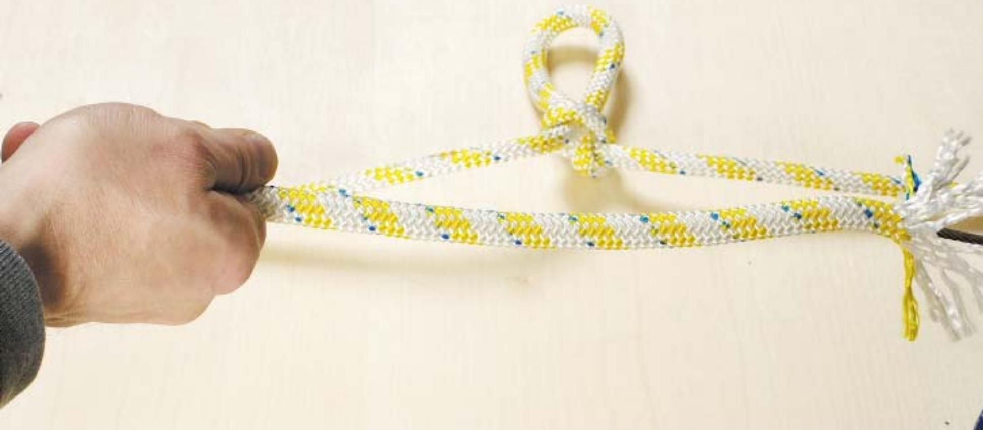
Faites repasser la gaine «retroussée» sur l'âme, en faisant disparaître l'épissure.
